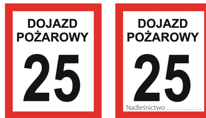
Rycina 2. Oznakowanie dojazdu pożarowego tablicą
